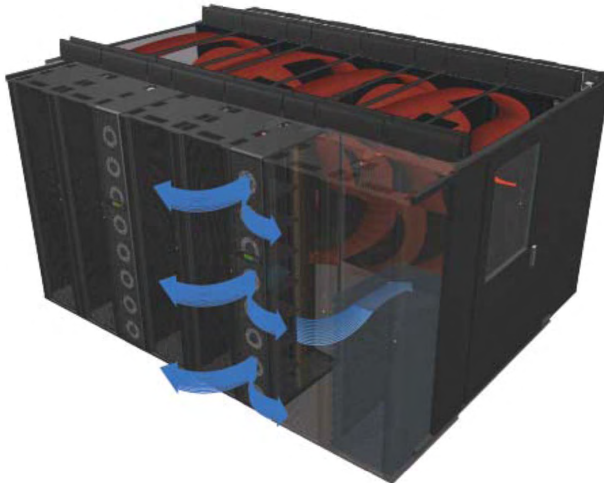
Распределение воздушных потоков внутри «кабинета» из ряда стоек
