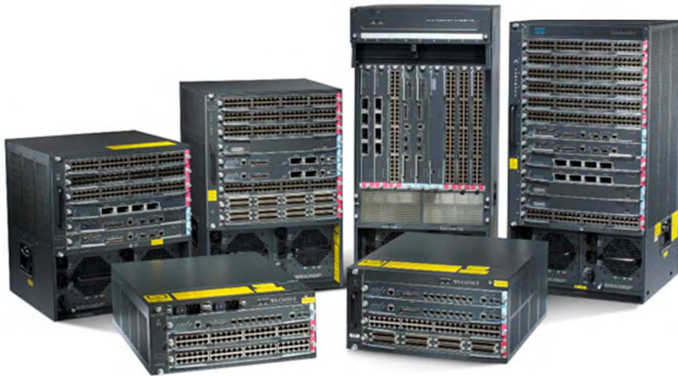
Коммутаторы ядра сети Cisco Catalyst 65xx
